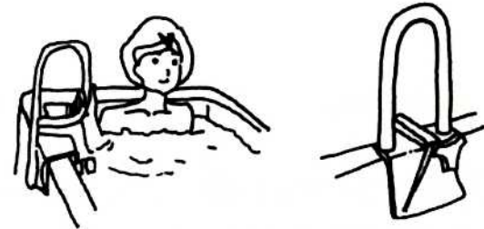
그림 69. 욕조에 설치하는 안전 손잡이
