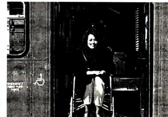
<사진 12> 리프트(Lift)식 장애인 전용버스
