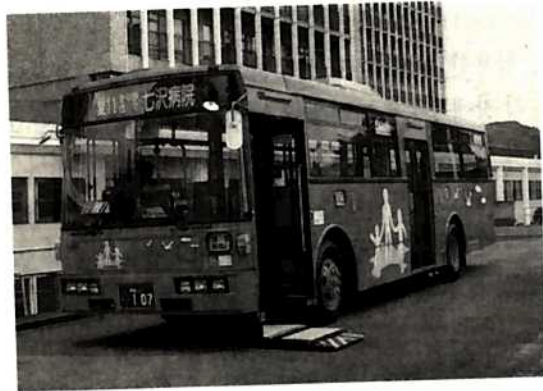
<사진 1> 대형버스를 이용한 STS 제공(광복문, 계단의 승강장치, 별도의 노선체계 등)
