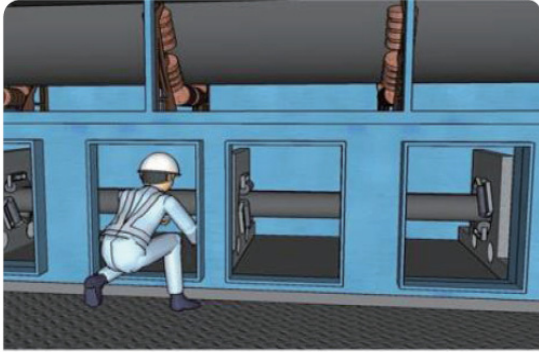
개방된 점검구에서 설비의 이상 유무를 확인하던 중 컨베이어에 몸이 말려들어가 1명 사망
