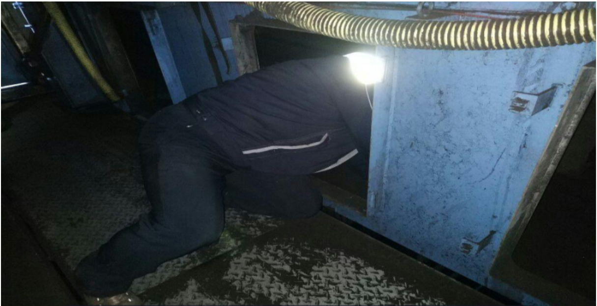
[그림 3] 공기부상형 벨트컨베이어 밀폐함 내 아이들러 롤러의 과열 및 소음 여부를 육안과 청각으로 확인하고 휴대폰으로 사진을 촬영하는 모습 연출 사진
