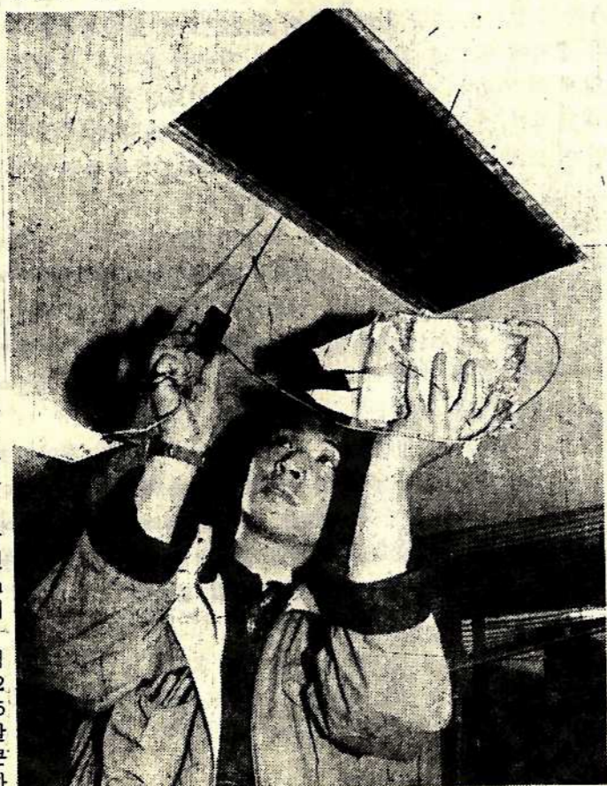
11일 오후 노문연 회원 1명이 사무실 천장에서 발견된 고성능 도청장치의 송신기와 건전지 뭉치를 들어보이고 있다. 송신기는 가스라이터 정도의 크기이며, 뭉치 안에는 10개의 건전지가 직·병렬로 연결돼 있었다. <진정영 기자>
