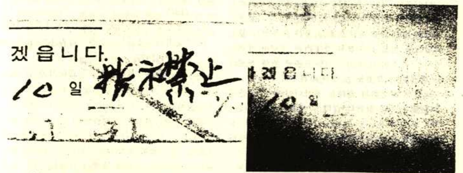
사진 10. 흑색볼펜으로 기재된 "指示禁止"가 (左) 赤外線 顯微鏡에 SPINDLER & HOYER IR filter(1060nm)를 使用한 사진상에서 불현출된 點으로 보아 筆記具의 ink成分이 다른 것으로 기재한 것을 알 수 있음 (右)
